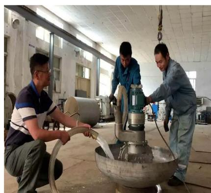
多管式自清洁甩干机技术经过多年研发，已开发设计3代样机，并开展了泥沙脱液分离试验，试验结果验证设备实现了滤网上颗粒的自团聚和滤网的自清洁，和自动排料，固液分离效果好，目前拟开展小批量试产。
