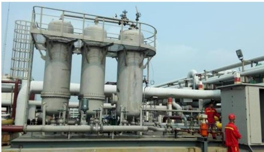
稠油采出液低温旋流脱水撬装装置
