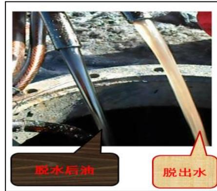
采出液地位预脱水工业试验
