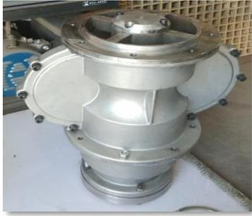
图 1 圆盘密封螺旋泵
