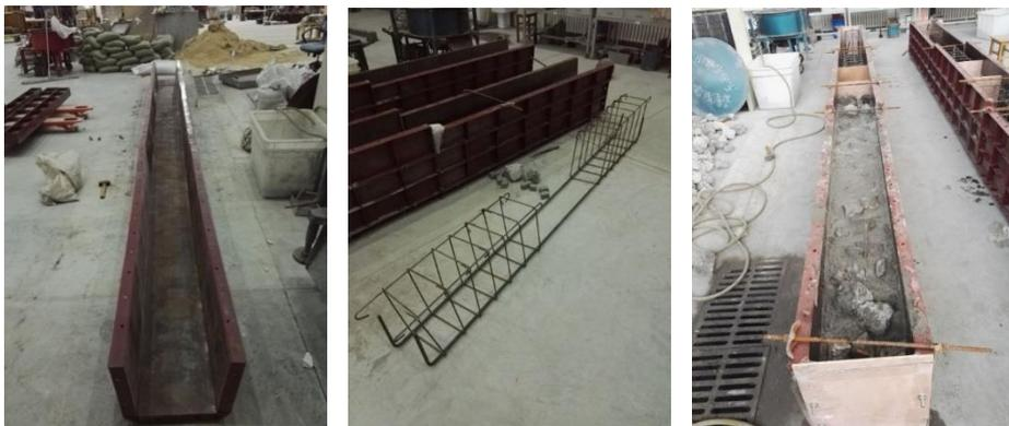
图 2 再生大骨料自密实混凝土梁制备
